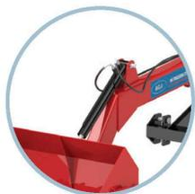
Acionada por pistão hidráulico proporciona maior facilidade para o acionamento, agilizando a operação
